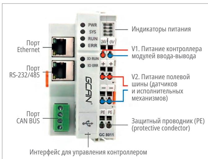
Рисунок 2. Контроллер GCAN-PLC-510 с модулем ввода питания GC-8011
