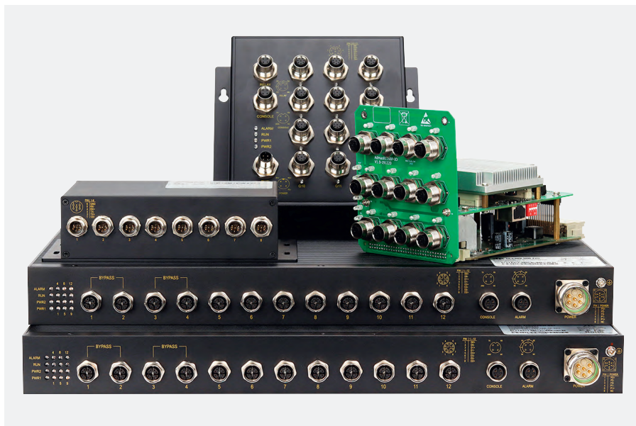
Рис. 8. Управляемые коммутаторы серии Advmas, соответствующие стандарту EN50155
