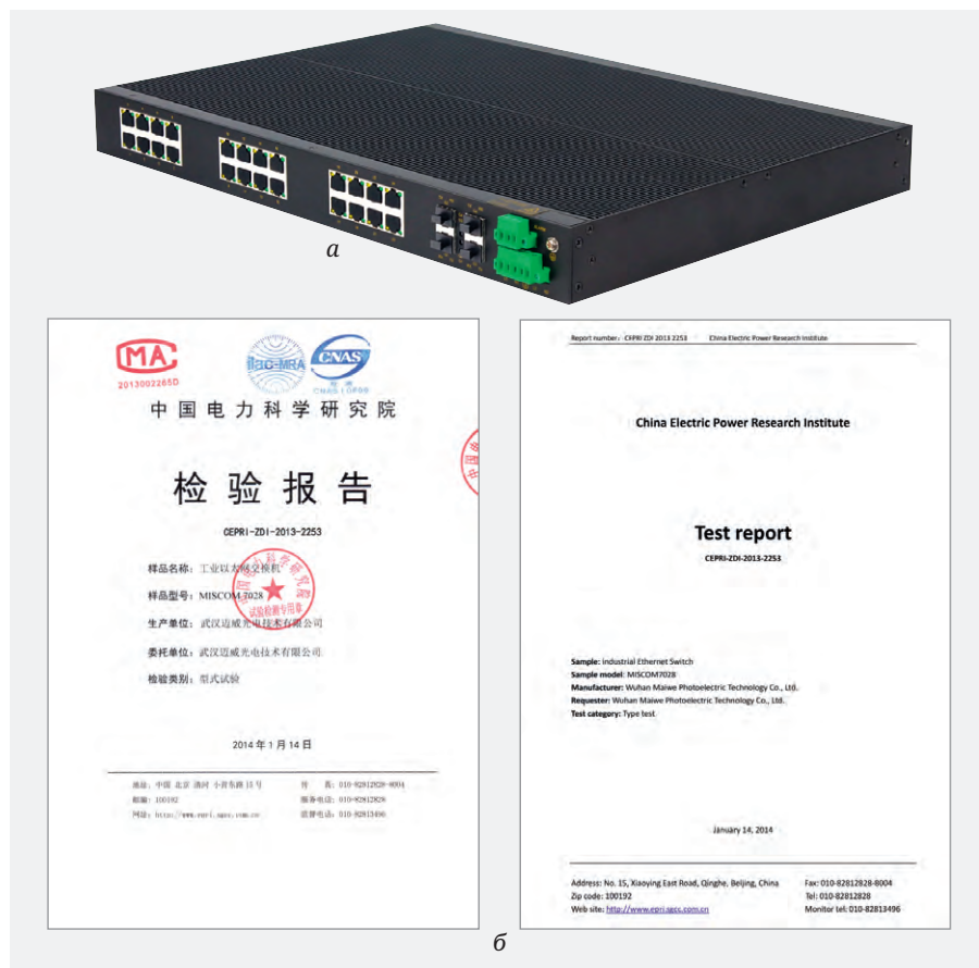
Рис. 7. Промышленный коммутатор серии MISC0M7028, ориентированный на применение в энергетике: а – внешний вид; б – тест-репорт на соответствие стандарту DL/T1241-2013 (Power Industry Ethernet Switch Technical Specifications)
