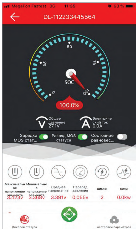
Рис. 6. Общая информация по состоянию батареи
