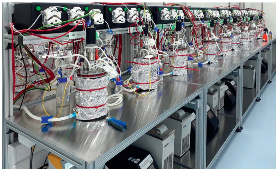
Рис. 6. Процесс культивирования клеток в лабораторных биореакторах
