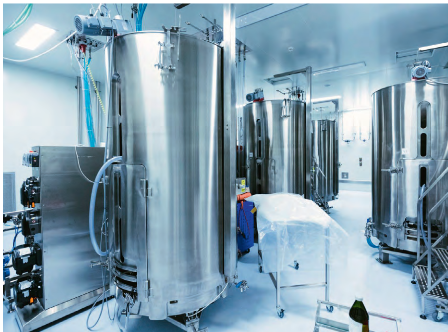
Рис. 2. Биореакторное помещение на заводе БИОКАД в поселке Стрельна. Оборудование в процессе наладки
