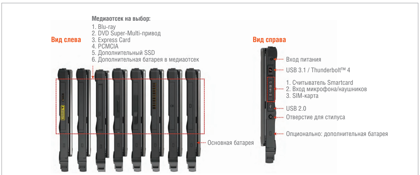
Рис. 5. S410G4 вид слева (медиаотсек) и справа
