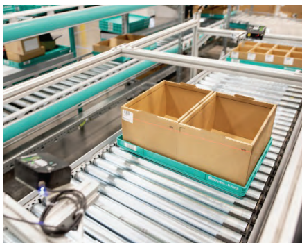
Рис. 5. Комплектовочные лотки на конвейере
