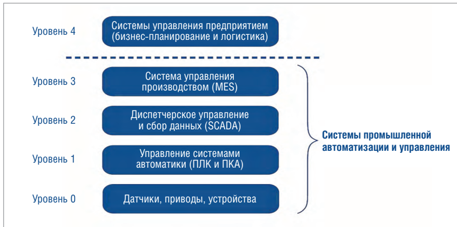
Рис. 2. Схема уровней системы промышленной автоматизации и управления
