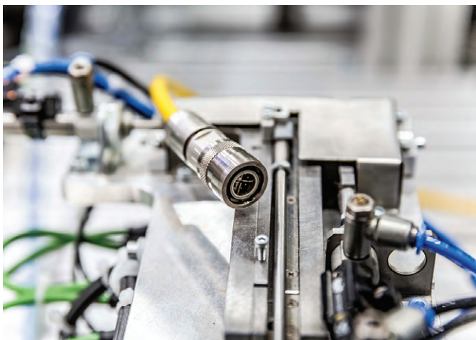
Рис. 4. HARTING PushPull RJ45 – соединитель для применения в машиностроительной отрасли
