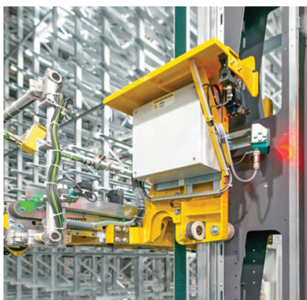
Рис. 4. Грузы размещают и извлекают автоматические штабелёры
