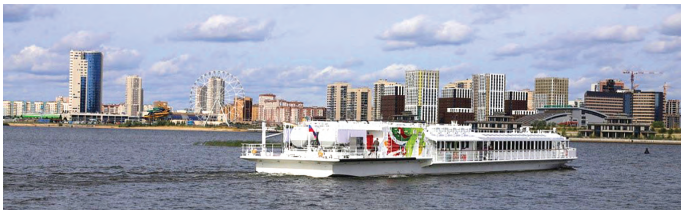
Рис. 1. Судно «Чайка», вид с кормы. Видны ёмкости криогенной бортовой газотопливной системы на палубе
