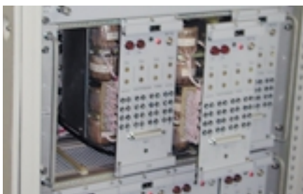
Рис. 7. Блоки БФ в стойке аппаратуры ФМ-канала
