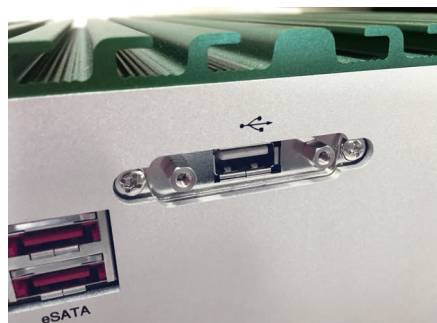
Рис. 4. USB-разъём с фиксацией на AdvantiX ER-5000
