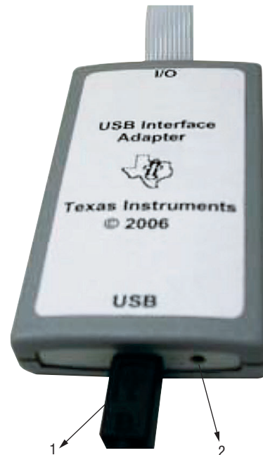
Условные обозначения: 1 – кабель USB; 2 – светодиодный индикатор подключения USB.
