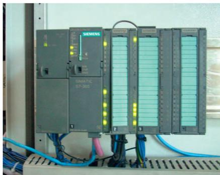
Рис. 2. Контроллер SIEMENS S7 315-2 DP/PN
