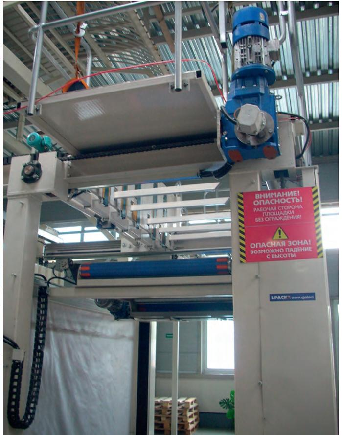
Рис. 5. Главный привод подъёмника с блоком концевых выключателей
