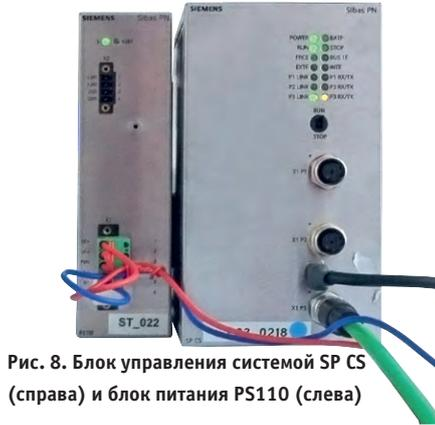
Рис. 8. Блок управления системой SP CS (справа) и блок питания PS110 (слева)
