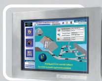
FPM-8151H монитор 15", IP65 резистивный сенсорный экран, диапазон рабочих температур -20...+60°C
