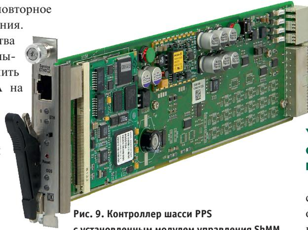
Рис. 9. Контроллер шасси PPS с установленным модулем управления ShMM
