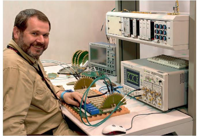
Рис. 3. Проверка целостности сигналов готовой кросс-платы
