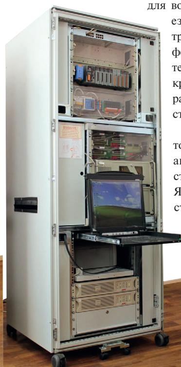
Рис. 2. АСУ ТП системы энергоснабжения Московского метрополитена
