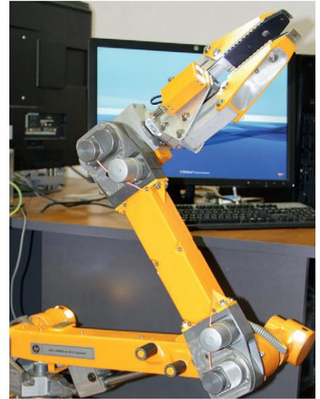
Рис. 5. Манипулятор точного позиционирования
