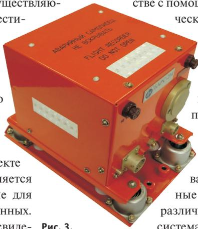
Рис. 3. Бортовой аварийный регистратор БАРС-2М
