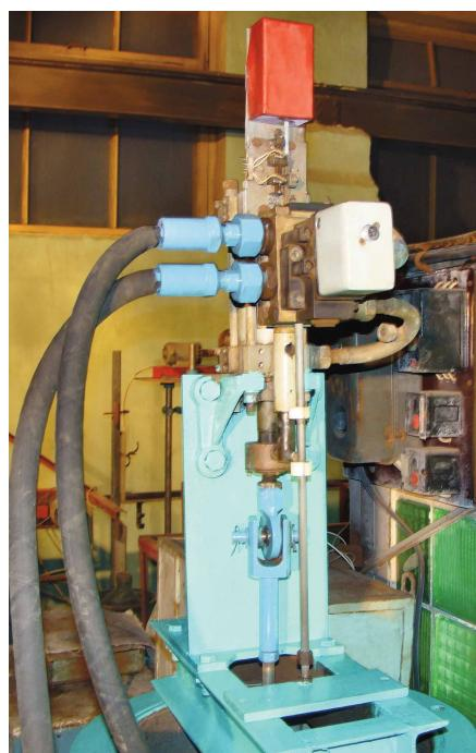
**Рис. 3. Гидравлический вибропривод**
