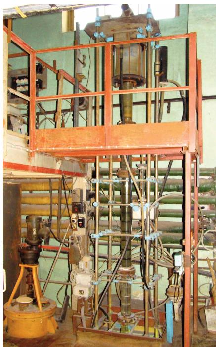
**Рис. 2. Вибрационная колонна высотой 5 м и диаметром 110 мм**
