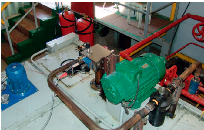
Рис. 6. Экспериментальные узлы управления адаптивного гидропривода
