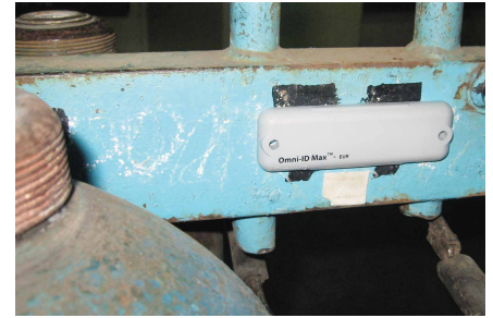
Рис. 3. RFID-метка на контейнере
