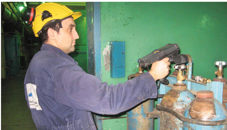
Рис. 4. Считывание данных мобильным RFID-терминалом
