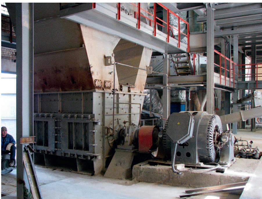
Рис. 1. Тангенциальная молотковая мельница со встроенным лабиринтным сепаратором
