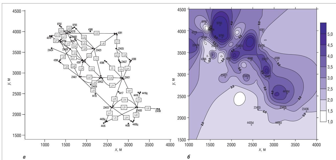
Рис. 3. План расположения скважин опытного участка (а) и карта распределения гидропроводности [ $\text{мкм}^2 \cdot \text{м}/(\text{МПа} \cdot \text{с})$ ] по данным гидродинамических исследований методом ФВД (б) [5]
