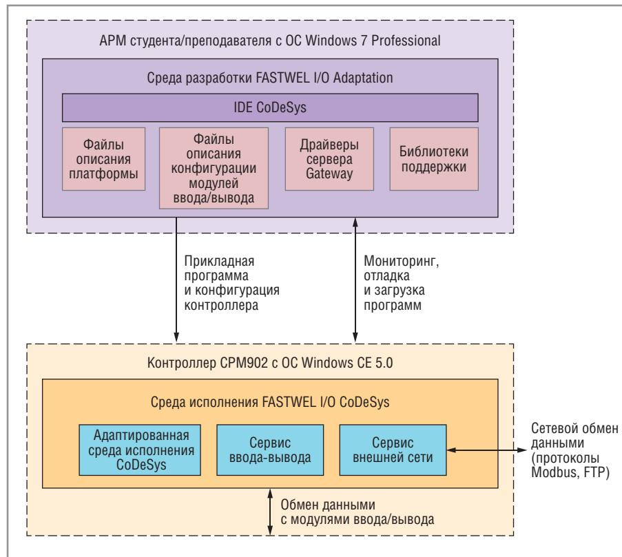
Рис. 9. Структурная схема комплекса программ FASTWEL I/O CoDeSys
