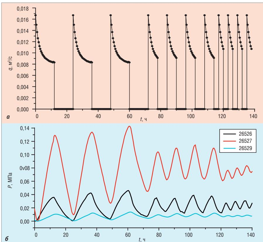
Рис. 2. Периодические колебания дебита ( $q$ ,  $\text{м}^3/\text{с}$ ), задаваемые с периодами 24, 12 и 6 часов на возмущающей скважине (а), и изменения давлений ( $P$ , МПа) на скважинах-приёмниках (б) [4]
