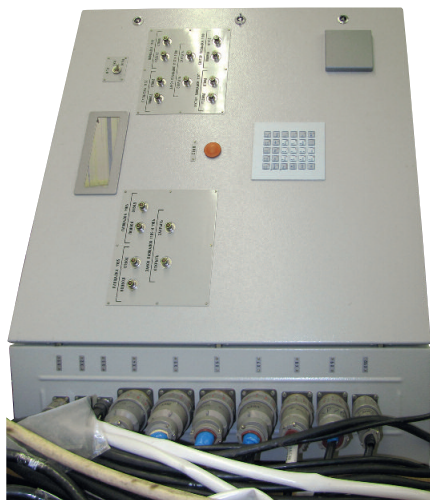
Рис. 6. Пульт управления площадками на отладочном стенде
