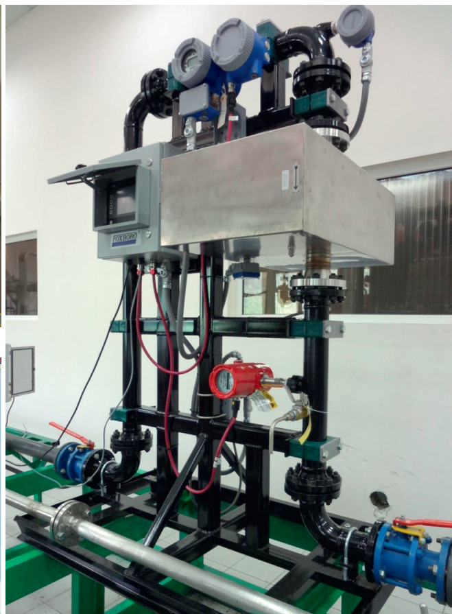
Рис. 9. Экспериментальные исследования многофазного расходомера NetOil&amp;Gas на эталоне ГЭТ 195-2011
