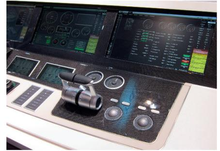
Рис. 3. 38-миллиметровый водонепроницаемый трекбол в рулевой рубке
