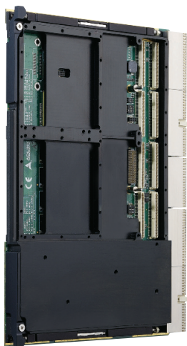
Рис. 5. CompactPCI-модуль с кондуктивным теплоотводом СТ-61
