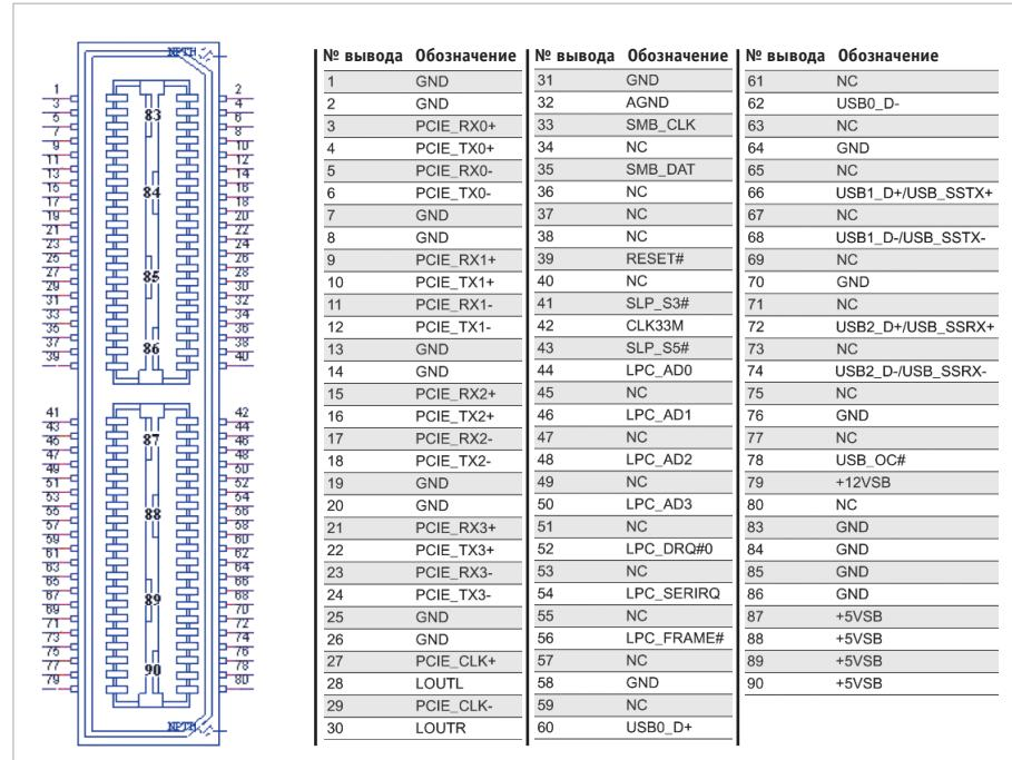
Рис. 1. Схема расположения выводов и распиновка разъёма Samtec QTE-040
