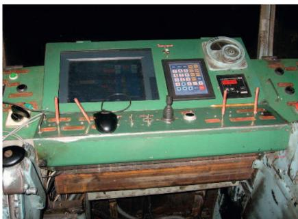
Рис. 4. Операторская станция с функциональной клавиатурой на главном посту управления
