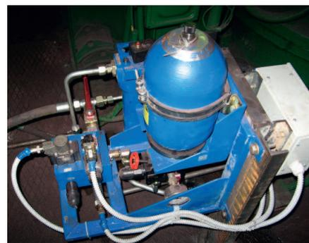
Рис. 8. Блок управления гидравликой
