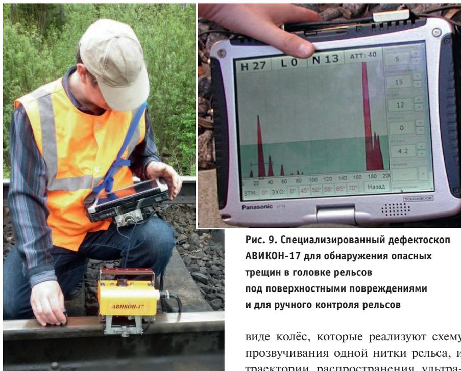
**Рис. 9. Специализированный дефектоскоп АВИКОН-17 для обнаружения опасных трещин в головке рельсов под поверхностными повреждениями и для ручного контроля рельсов**
