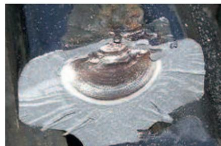
Рис. 5. Развитие поперечной трещины от повреждения на поверхности катания головки рельса
