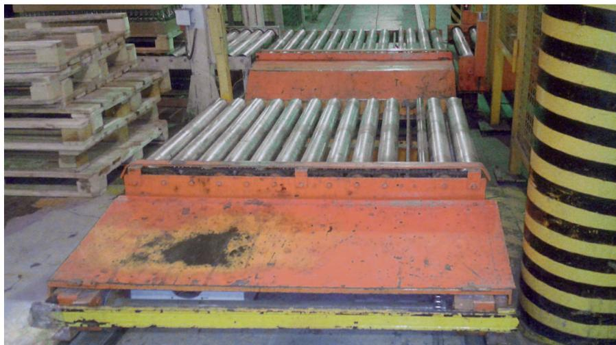
Рис. 2. Внешний вид конструкции шаттлов
