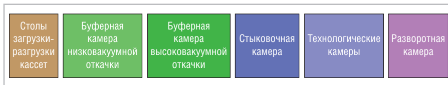
Рис. 1. Компонентная схема машины линейного типа
