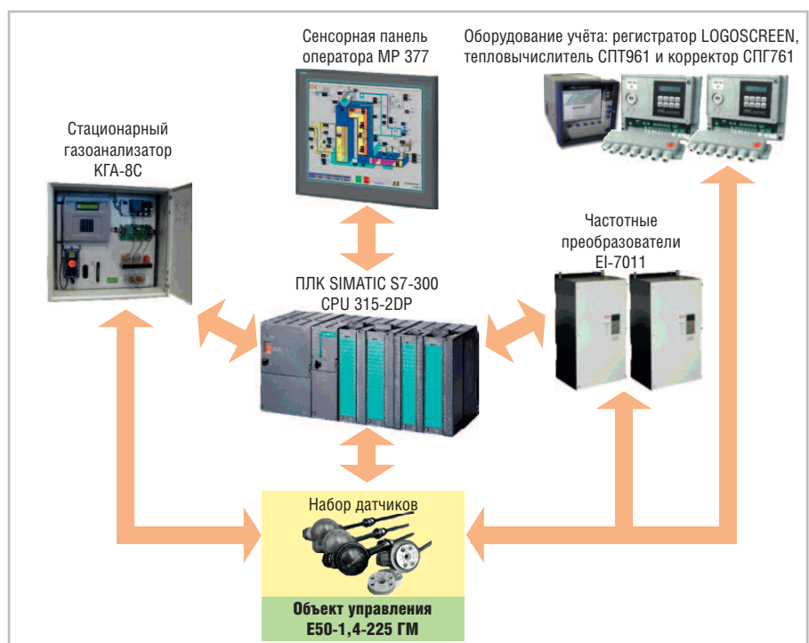
Рис. 1. Структурная схема КТСА
