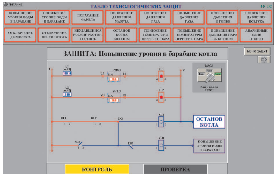
Рис. 6. Экран контроля состояния технологических защит
