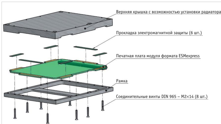
Рис. 1. Схема конструкции КМ ESMexpress согласно стандарту ANSI/VITA 59
