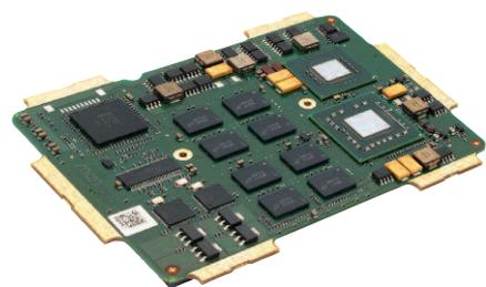
Рис. 3. Компьютерный модуль формата ESMexpress XM2 с процессором Intel Core 2 Duo
