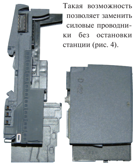
Рис. 3. Сравнение габаритов модулей ET200S (снизу) и ET200SP (сверху)
