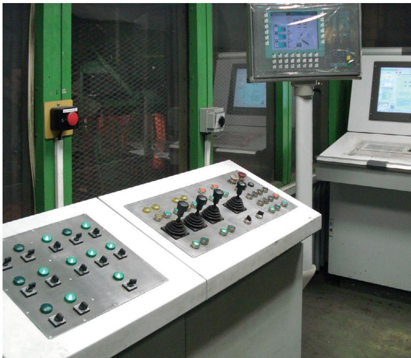
**Рис. 2. Пульт управления в диспетчерском пункте (на заднем плане видны панели оператора, относящиеся к устройствам человека-машинного интерфейса верхнего уровня системы управления)**
