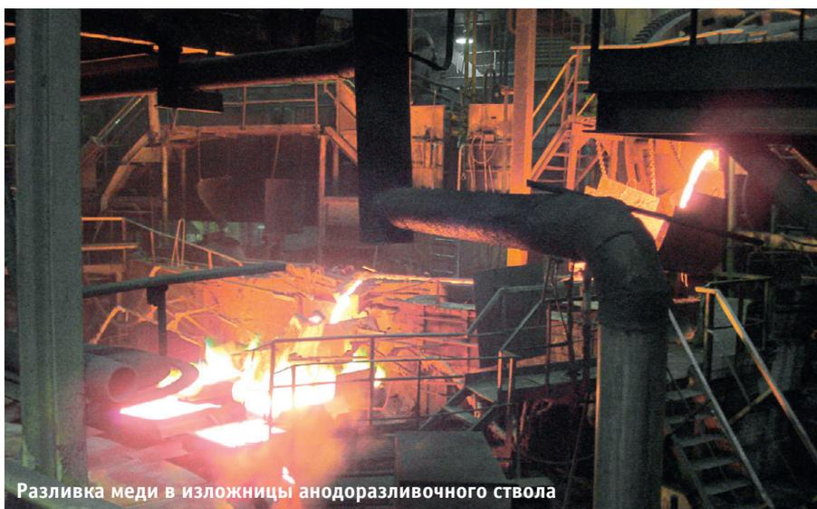
Разливка меди в изложницы анодоразливочного створа
