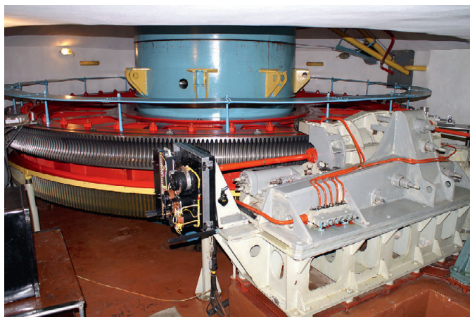
Рис. 4. Привод азимутальной оси с открытым отсчётным блоком
