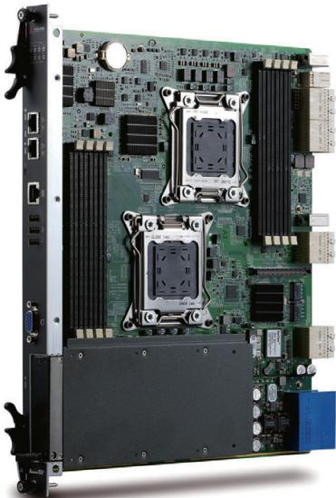
**Рис. 7. Процессорная плата аТСА-6200**
