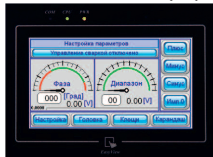
Рис. 3. Панель управления установкой контактной сварки
