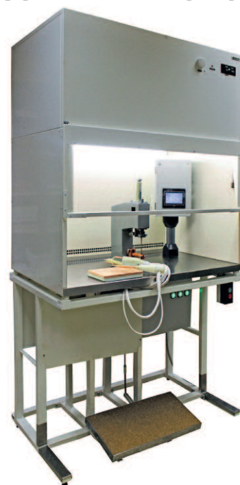
Рис. 1. Установка контактной точечной сварки
