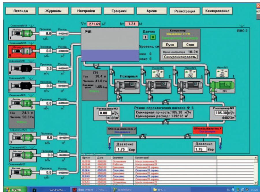
Рис. 4. Копия экрана АРМ диспетчера
