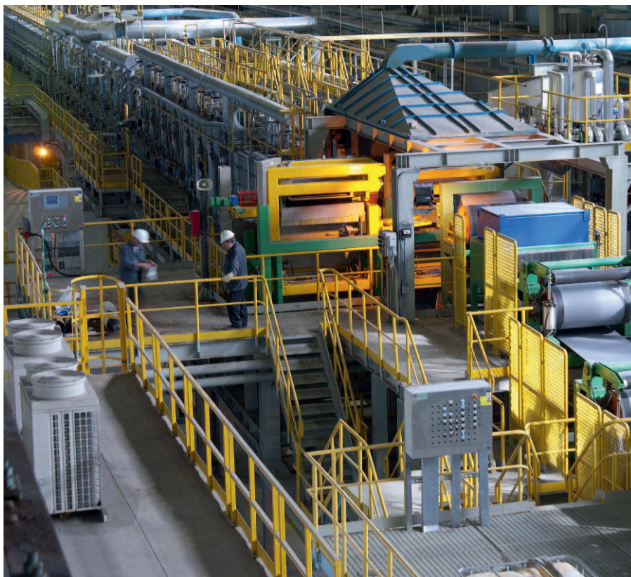
Рис. 1. Выходная часть агрегата выпрямляющего отжига
