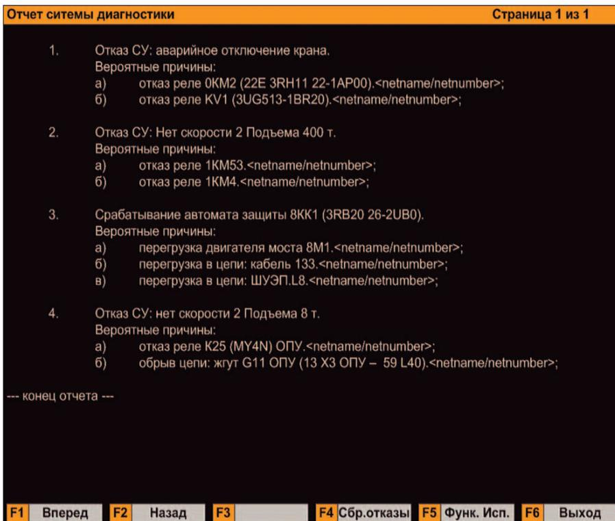
Рис. 9. Копия экрана с отображением отчёта системы диагностики
