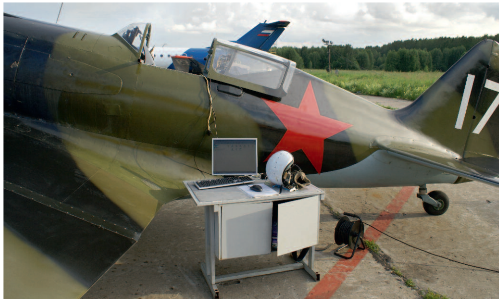
Рис. 11. Применение МСБИ при испытаниях самолёта-реплики МиГ-3
