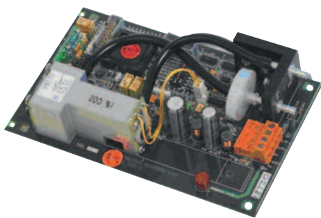
Рис. 1. Инфракрасный газовый сенсор Gascard II
