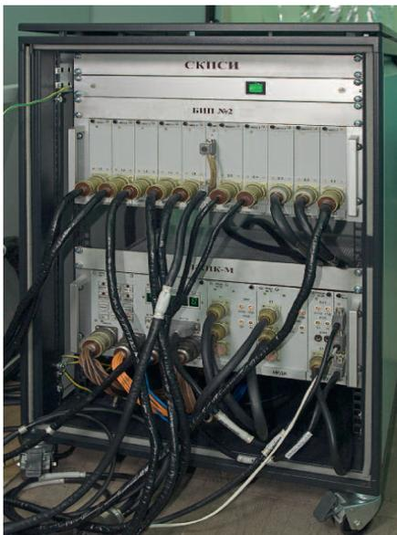
Рис. 5. Крепление блоков и модулей в стойке
