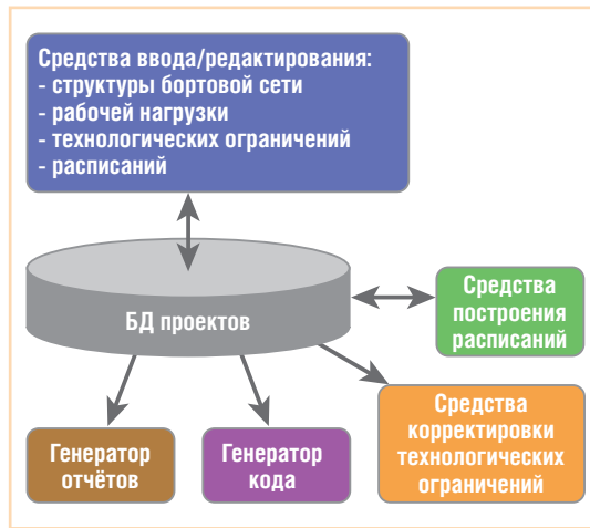
Рис. 4. Структура инструментальной системы «САПР циклограмм»
