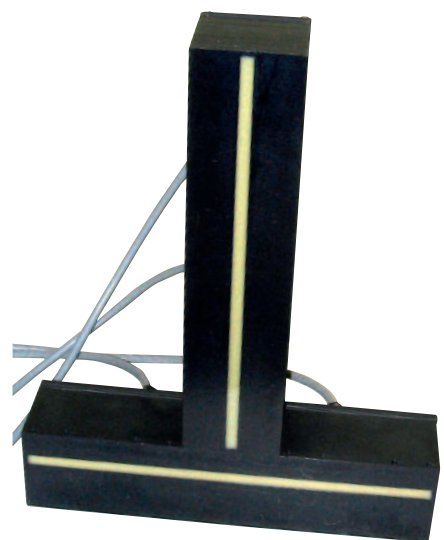
Рис. 5. Приёмно-излучающая антенна экспериментального стенда
