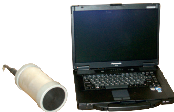
Рис. 10. Малогабаритный 3D-звуковизор с рабочей частотой 1 МГц (в качестве надводного модуля обработки и отображения – защищённый ноутбук Panasonic CF-52)
