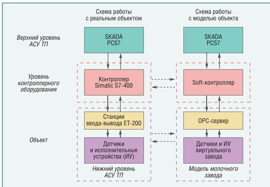
Рис. 1. Структурная схема программно-аппаратного комплекса АСУ ТП
