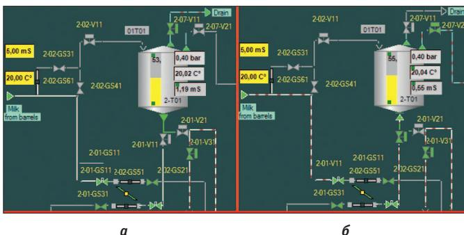
Рис. 5. Вид приёмного танка на участке приёмки молока в среде PHMIE: а – в состоянии ожидания; б – во время перекачки
