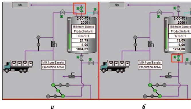
Рис. 6. Вид приёмного танка на участке приёмки молока в среде Siemens WinCC PCS7: а – в состоянии ожидания; б – во время перекачки
