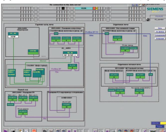
Рис. 3. Архитектура аппаратных средств системы сбора данных печи
