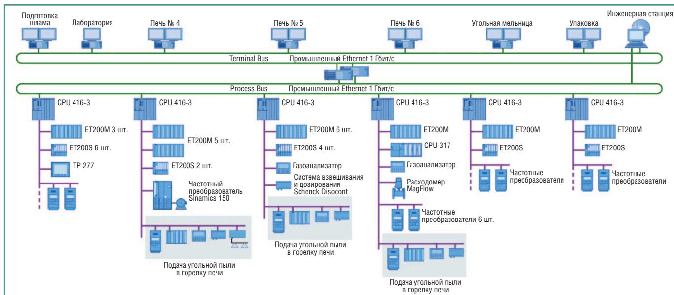
Рис. 1. Структурная схема автоматизированной системы управления заводом
