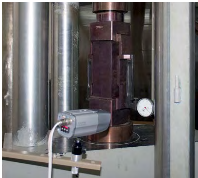
Рис. 4. Фрагмент установки с размещённой видеокамерой при проверке динамометра ДС-2000
