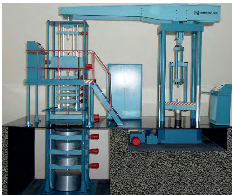
Рис. 1. Внешний вид машины ОСМ2-200-10 (фотография макета)
