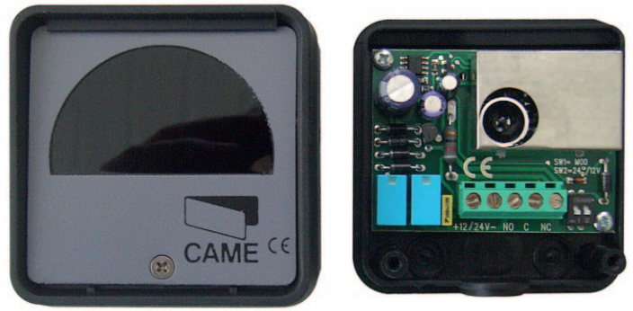
Рис. 3. Источник и приёмник (верхняя крышка снята) ИК-излучения
