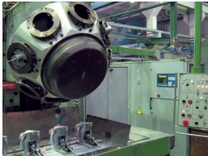
Рис. 4. Станок МА655А3 с заменённой системой управления «Курс»
