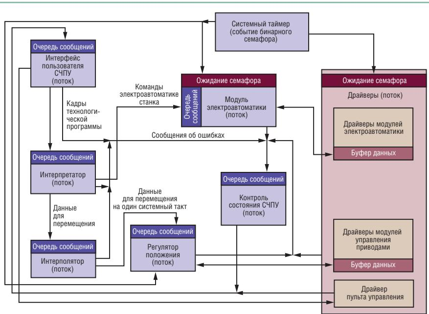
Рис. 2. Структурная схема системы ЧПУ «Феникс», построенной на базе On Time RTOS-32
