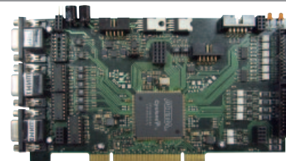
Рис. 8. Макет разрабатываемой платы ввода-вывода в форм-факторе PCI
