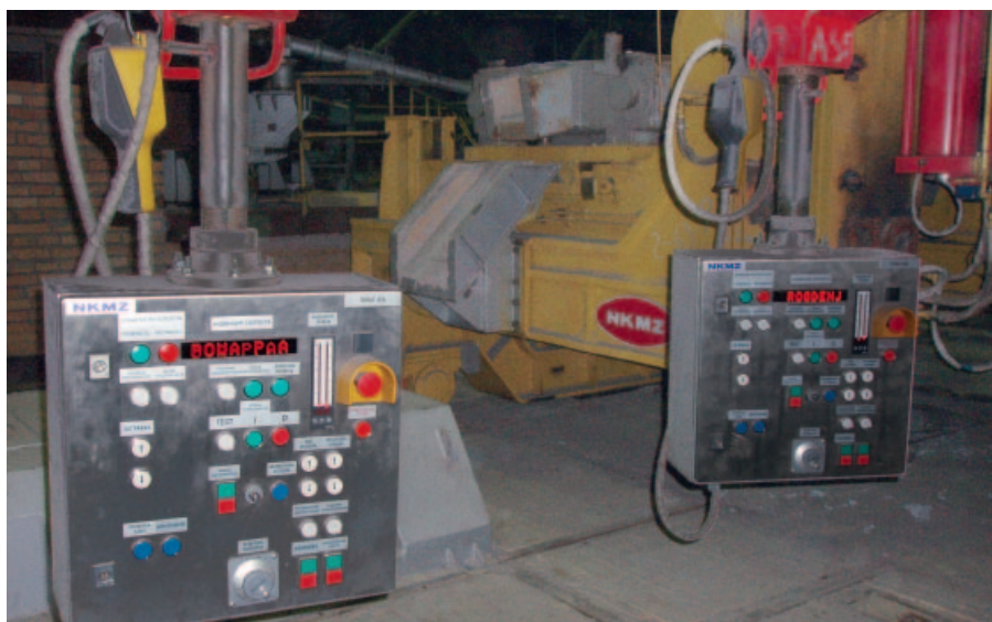
Рис. 7. Разливочная площадка с пультами разлищиков
