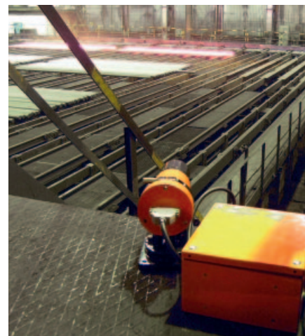
Рис. 4. Размещение оптической камеры при испытаниях
